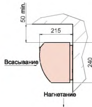
Крепление к стене тепловой завесы RM-0615, RM-0915, RM-1215
